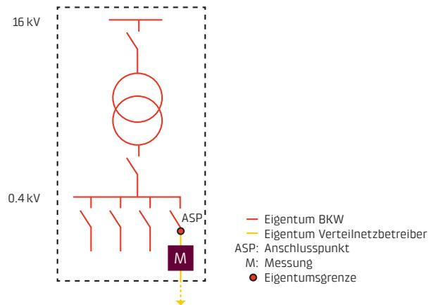
2.7.1.2 Verteilnetzbetreiber Mittelspannung 12- bzw. 16-kV:
