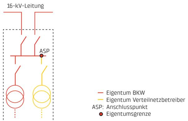
16-kV-Sammelschiene vor dem Übergabefeld des Kunden. Bei Kompaktanlagen ist die Eigentumsgrenze zwischen dem Trafobereich der BKW und dem Trafo des Kunden. Befinden sich in der Station ausschliesslich Transformatoren des Kunden, ist das Gebäude in sei-
