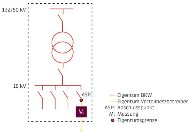
station nach dem Abgangsfeld der BKW. Die Kabelendverschlüsse gehören zur Kundenanlage.
